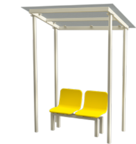
Bancas plásticas y techo de policarbonato 2 Bancas de Árbitros con Techumbre DEP-MO-01-00 Largo: 1.60 m Ancho: 1.15 m Alto: 2.15 m Área mínima: 2.60 m x 1.15 m Usuarios: 2 personas
